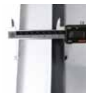
Parede com isolamento de 80 mm
